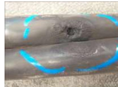
水トリ-による絶縁破壊事例
