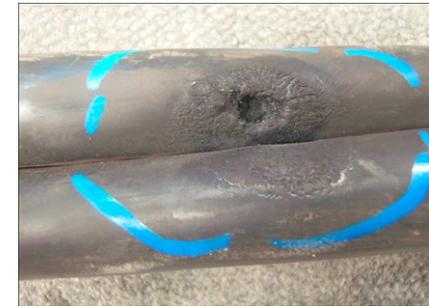
水トリーによる絶縁破壊事例
