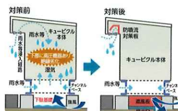
キュービクルの雨水等浸入対策
